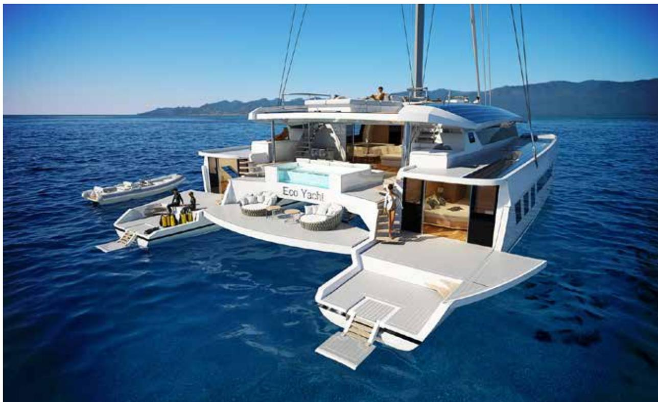
Autre prouesse, une surface de 70 m<sup>2</sup> de panneaux solaires intégrés dans la coque garantira les besoins en énergie de la vie à bord, et une navigation côtière sans émission de CO<sup>2</sup> ni décibel.
